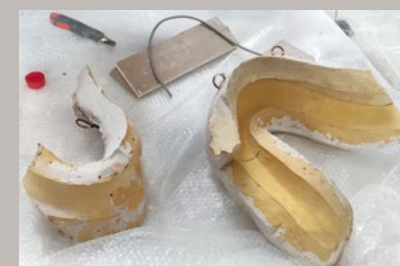
↑ Tvorba lukoprénové formy a výsledný sádrový odlitek chybějící části plastiky
